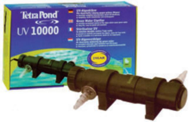
уверенностью без всяких расчетов уничтожать в воде всю микрофлору и фауну, даже используя гораздо более мощные помпы, от 1000 л/ч, необходимо использовать стерилизаторы с рабочим диаметром не превышающим 4–5 мм, при длине прохождения потока через такие облучатели не менее 40 см.
