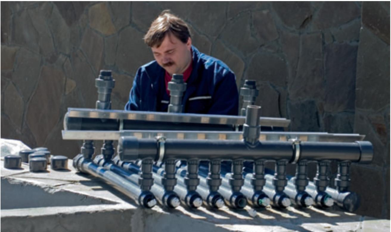
Этот мощный десятисекционный УФ-стерилизатор уникальной конструкции, предназначенный для высокопроизводительной комплексной фильтр-системы, обслуживающей большой садовый пруд с высокой плотностью посадки рыбы, разработан компанией «Aquaanimals».
